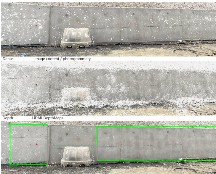
Dense & Depth fused는 Dense와 Depth 포인트 클라우드를 하나로 결합합니다.
