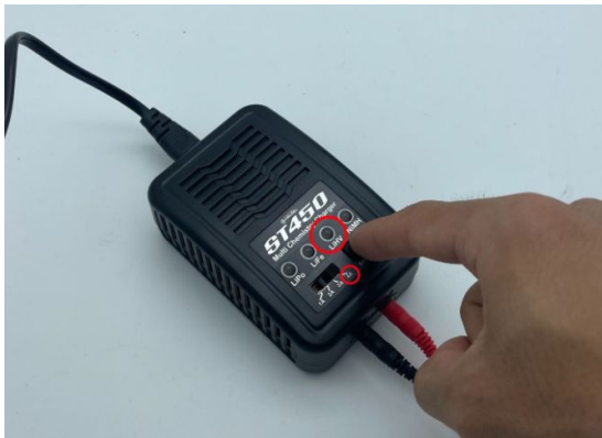
(3) LED가 초록색, 빨간색으로 번갈아가면 깜박이면 충전 준비가 완료된 것이며, 'LiHV' 버튼을 누른 뒤 슬라이더 부분을 '4A'로 맞춰준다.
